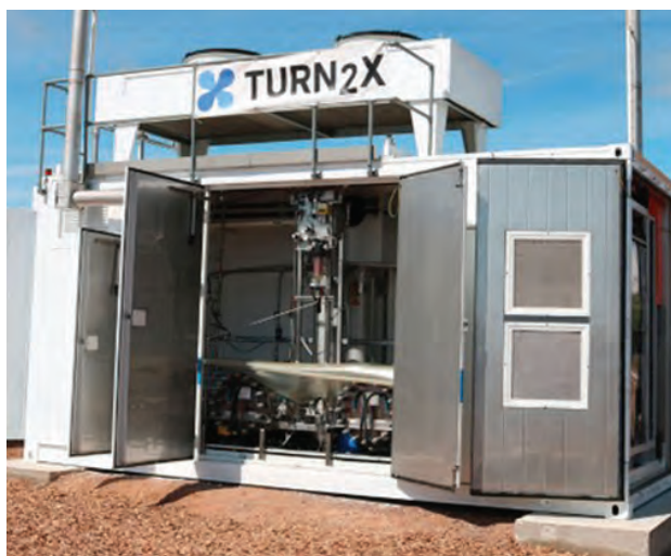
Instalación de Turn2x en Miajadas para la metanización del hidrógeno, que ya produce gas verde
